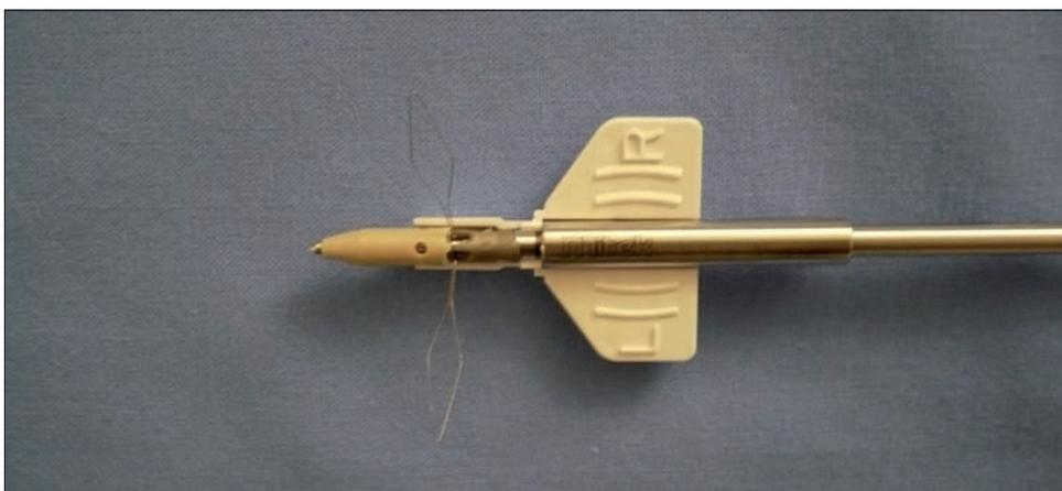
**Abb. 3.20:** Knotenloser Anker zur arthroskopischen Rotatorenmanschetten-Rekonstruktion, Kombination aus PEEK und Titan. Die Fixation des Fadens erfolgt durch Verklebung im Anker (VERSALOK, DePuy Mitek, Boston, USA).
